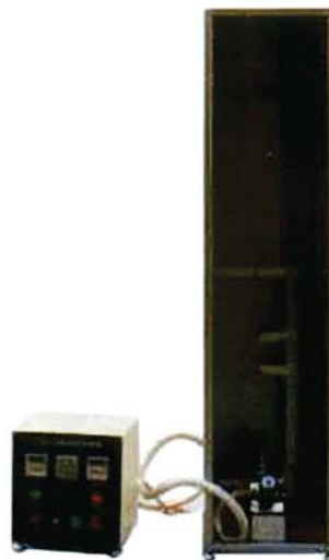
Máy thí nghiệm đốt cháy thẳng đứng dây điện nhỏ cách điện 1 lõi đồng: - Phù hợp tiêu chuẩn: GB/T18380.12, IEC 60332-2.
