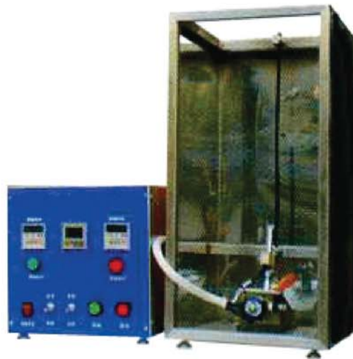
Máy thí nghiệm đốt nghiêng dây điện cáp điện 1 sợi: Phù hợp tiêu chuẩn: GB12666.4
