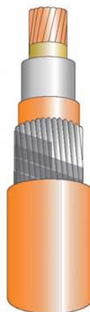
AWA: Aluminium wire armoured (Giáp sợi nhôm)
