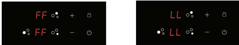
Hình 1: Lỗi ánh sáng môi trường xung quanh cảm biến hồng ngoại
