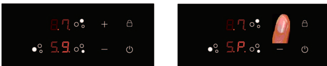
Hình 11: Lựa chọn mức công suất với phím [+]/[-]
