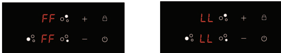
Fig. 1.: Infrared Ambient Light Error
